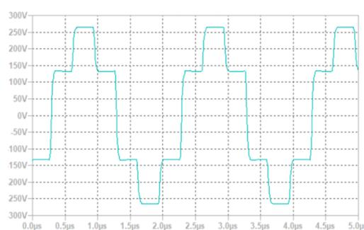
Abb.8: primäre Strangspannung zwischen Brückenausgang und Sternpunkt
