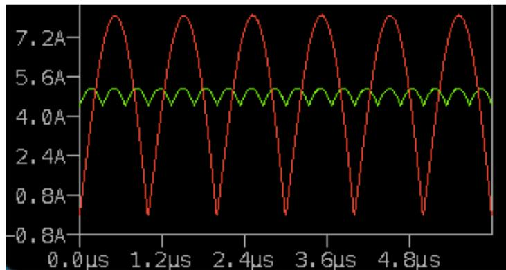
Vergleich Ausgangsströme  $i$  (siehe Schaltbild) bei gleichen Ausgangsspannungen und -strömen
